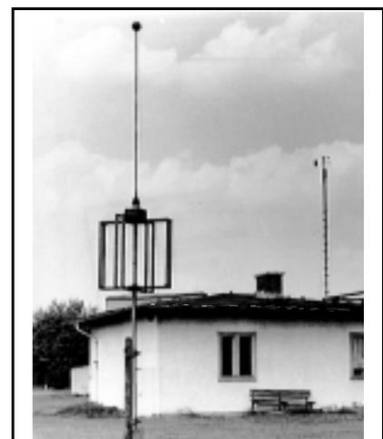
Abbildung 12. Rahmenantenne für die Gewitterortung im Nahbereich. Dahinter das Tempelhofer Stationsgebäude (Foto PELZ)
