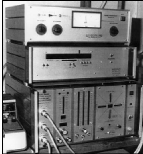
Abbildung 14 Gewitterortungsanlage für den Nahbereich. Unten das Ortungsgerät. Links die drei Antennenanschlüsse für die elektrische und die beiden magnetischen Komponenten. Darüber das Interface für den Rechneranschluß, oben der Nahblitzzähler.
