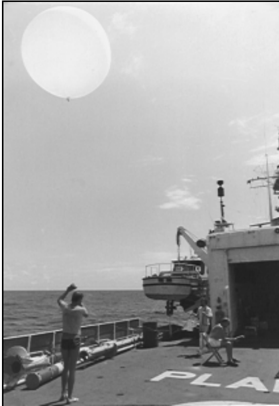
Abbildung 9 Start einer Radiosonde vom Hubschrauberdeck der PLANET. Am Ballonseil ein Matrose, mit der Sonde Wolfgang WICHMANN (Berlin) (Foto PELZ)
